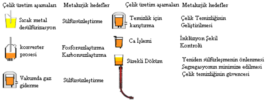
Şekil 3.12 Asidik servisler için yüksek temizlik derecesinde çeliklerin üretim aşamaları (Hillenbrand vd., 2001)
