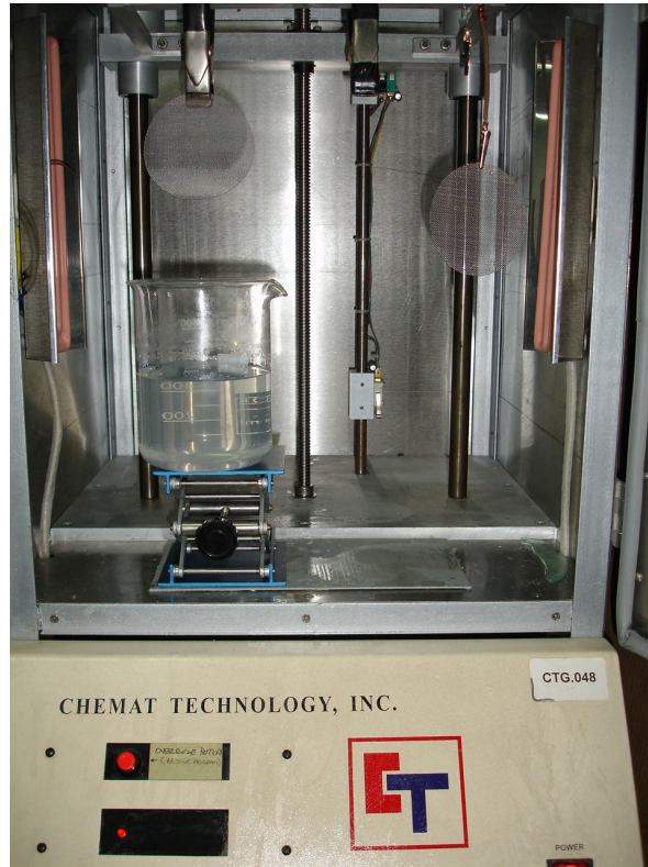
Şekil 3.42 Paslanmaz çelik tel kafeslerin daldırma yöntemiyle kaplanması
