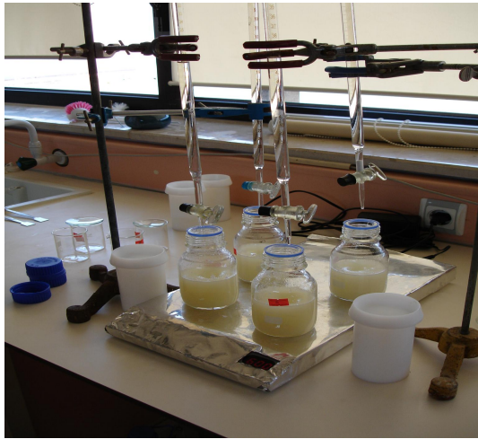
Şekil 3.8 Hidrotermal yöntem ile nano TiO 2 sentezi için çözelti hazırlanması
