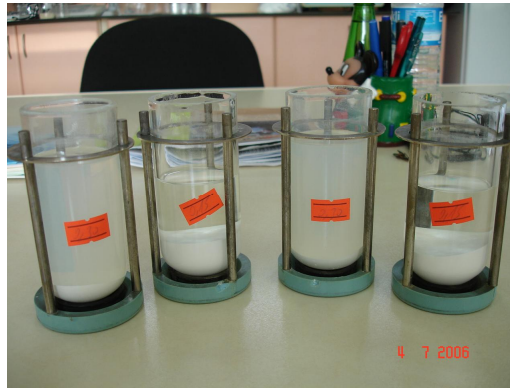
Şekil 3.3 Sol-jel yöntemi ile sentezlenen nano TiO 2 tozlarının santrifüjlenmesi
