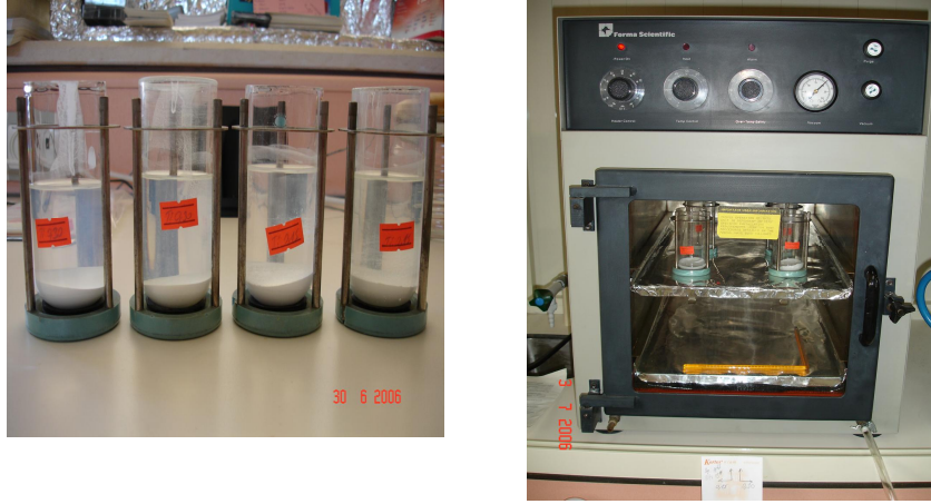
Şekil 3.11 Hidrotermal yöntem ile sentezlenen TiO_2 tozlarının santrifüjlenmesi ve kurutulması
