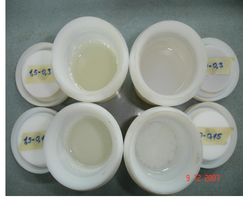
Şekil 3.9 Hidrotermal yöntem ile sentez için karışımların hazırlanması ve teflon kaplara aktarılması
