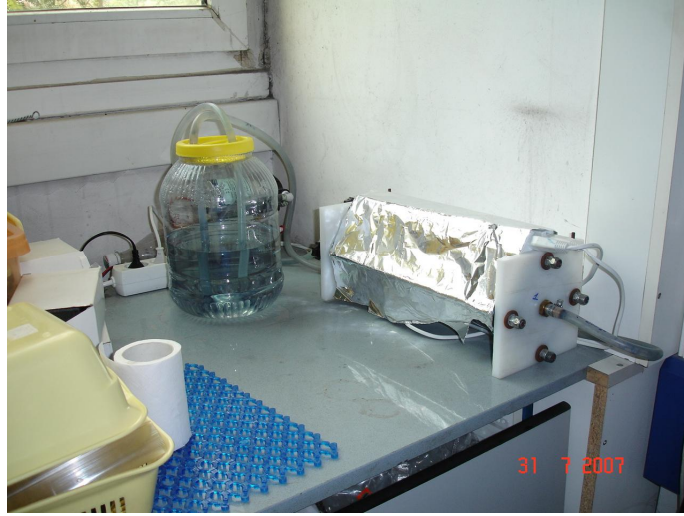
Şekil 3.57 Metilen mavi tekstil boyası için fotokatalitik uygulama
