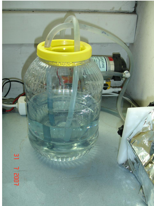
Şekil 3.58 Metilen mavi boyar maddesinde fotokatalitik etkinin gözlemlenmesi
