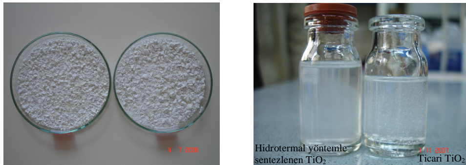
Şekil 3.12 Hidrotermal yöntem ile sentezlenen TiO_2 tozları ve ticari TiO_2 ile disperse ortamda kıyası
