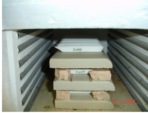
Şekil 3.5 Sol-jel yöntemi ile sentezlenen nano TiO 2 tozlarının 500 °C de ısıtılması
