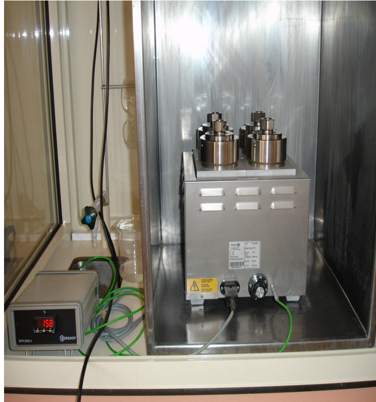
Şekil 3.10 Hidrotermal yöntem ile tozların sentezlenmesi
