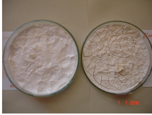
Şekil 3.4 Sol-jel yöntemi ile sentezlenen nano TiO 2 tozlarının jel hali
