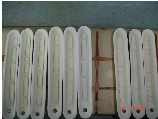
Şekil 3.6 Sol-jel yöntemi ile 500 °C de ısıtılma sonrası elde edilen anataz formdaki nano TiO 2 tozları
