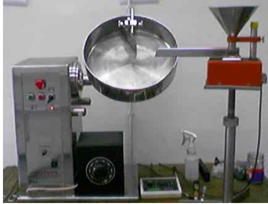
Şekil 8.1 Deneysel çalışmalarda kullanılan multipex marka küresel pelet makinesi ve apex vibratory feeder marka vibratör cihazı
