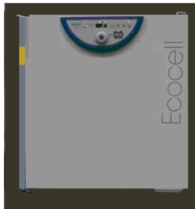
Şekil 8.2 Deneysel çalışmalarda kullanılan ve şekillendirilen küresel peletlerin kurutma işlemlerinin yapıldığı maksimum 300°C'ye çıkabilen etüv
