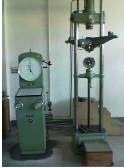
Şekil 8.3 Deneysel çalışmalarda kullanılan ve peletlerin mukavemet testini ölçen mohr bfederhoff ag marka universal tip hidrolik çekme makinesi
