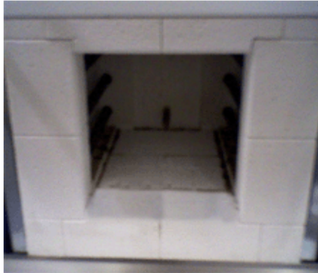
Şekil 8.5 Deneysel çalışmalarda yarı ergitme şartlarında indirgeme deneyleri için kullanılan Protherm marka laboratuvar tipi elektrik reistanslı kutu fırının iç haznesinin görüntüsü
