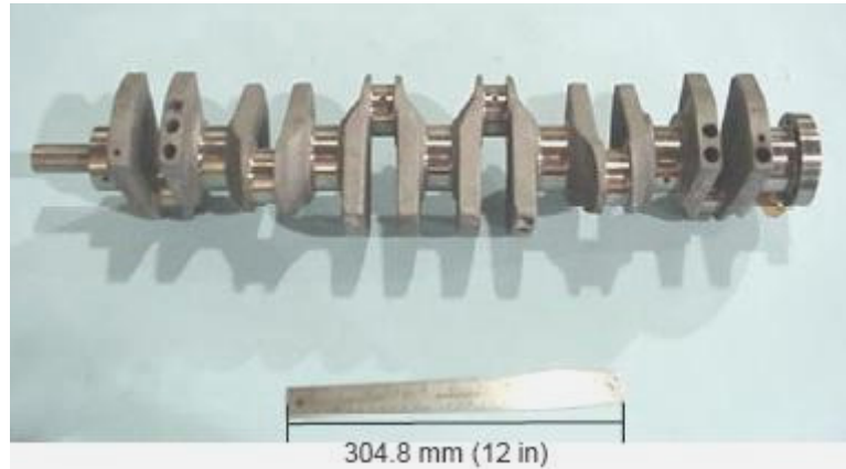
Şekil 1.3 ÖKGDD krank mili (Hayrynan, Brandenburg ve Keough, 2002)
