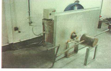
Şekil 5.3 LPG veya doğal gazla çalışabilen pota ısıtma sistemi
