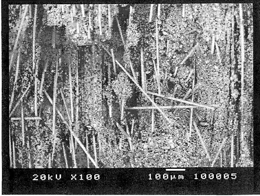
Şekil 4.8 DP1-N 5 (kenar) No'lu numunenin kırık yüzeyinin görünümü (SEM).
