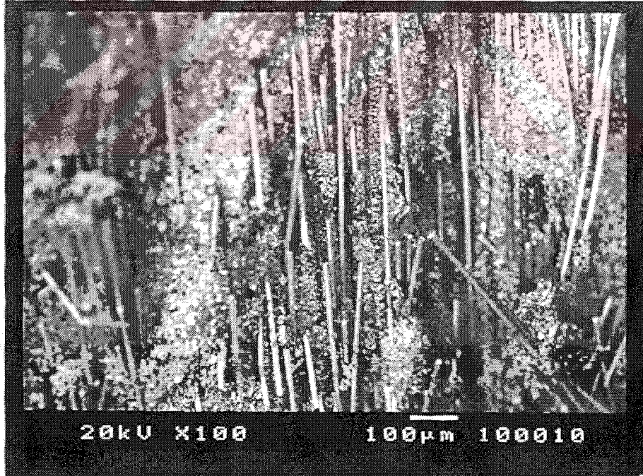
Şekil 4.9 DP1-N 10 (merkez) No'lu numunenin kırık yüzeyinin görünümü (SEM).
