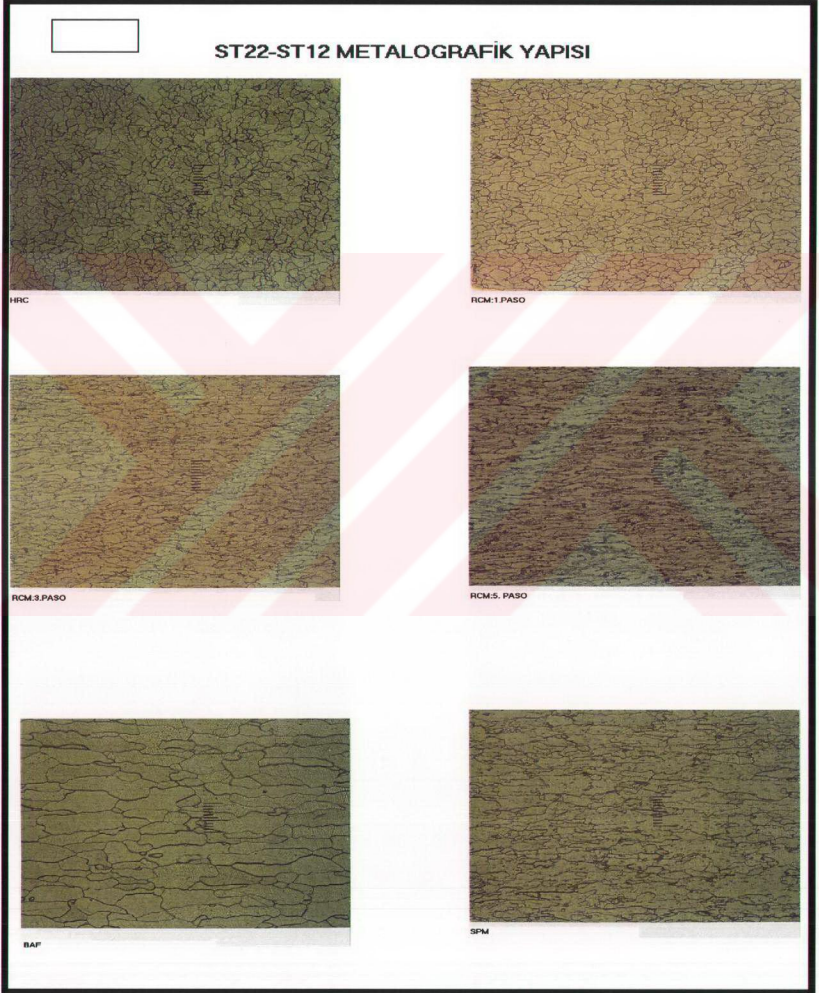
Şekil 7.42 St 22 hammaddeden St 12 final ürüne kadar metalografik inceleme sonuçları
