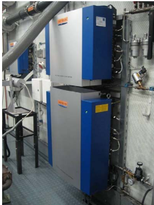
Şekil 4. 3 Deneylerde kullanılmış olan AVL 735S yakıt sarfiyatı ölçüm ve AVL 753C yakıt sıcaklığı kontrol cihazı kombinasyonu.
