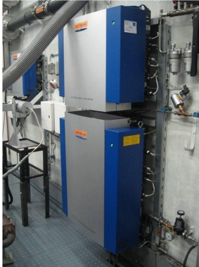
Şekil 5. 4 Deneylerde kullanılmış olan AVL 735S yakıt sarfiyatı ölçüm ve AVL 753C yakıt sıcaklığı kontrol cihazı kombinasyonu.
