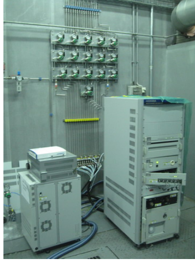
Şekil 5. 6 Deneylerde kullanılmış olan Horiba Mexa 7100 DEGR egzoz emisyon ölçüm cihazı
