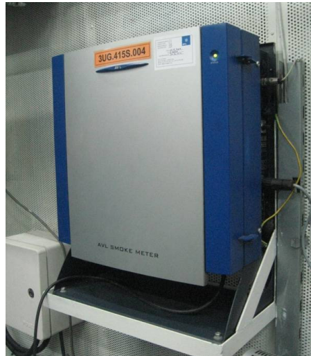
Şekil 5. 5 Deneylerde kullanılmış olan AVL 415S is ölçüm cihazı
