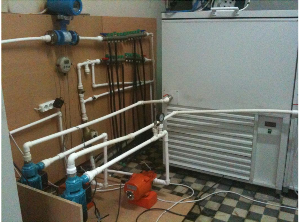
Şekil 4. 3 Su banyolarında hazırlanan suyun tesisata aktarımı ve dolaşımı
