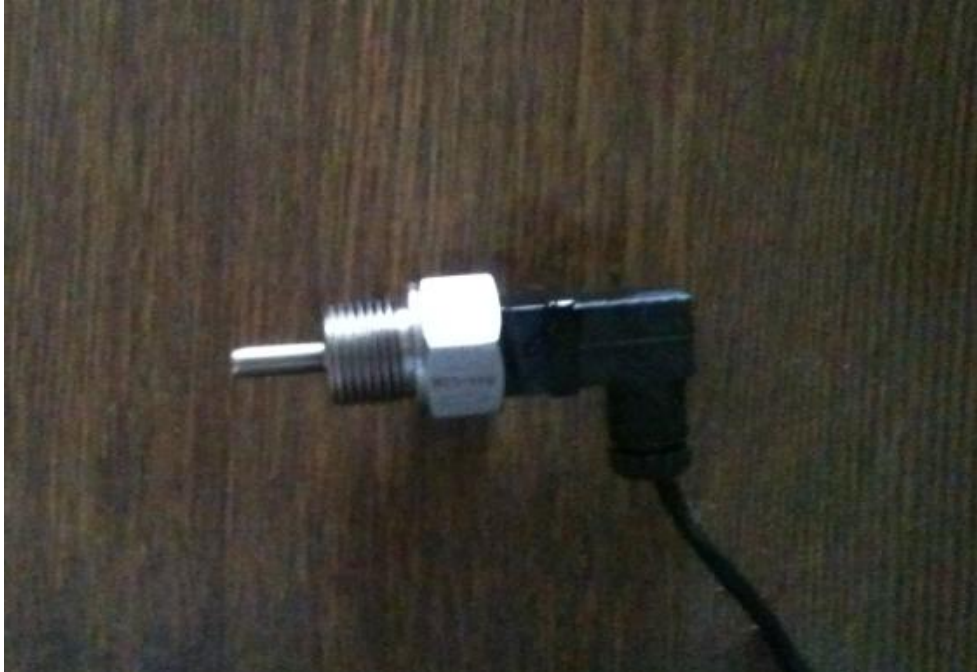
Şekil 4. 15 Panel giriş ve çıkışlarında su sıcaklığı ölçümü için T parçacıkları üstüne konan PT 100
