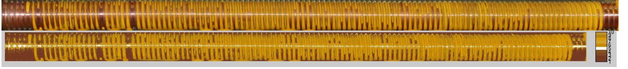
Şekil 4. 33 Burgulu üçgen yivli borunun ıslaklık yüzey alanı ve görüntü işleme sonrası resmi
