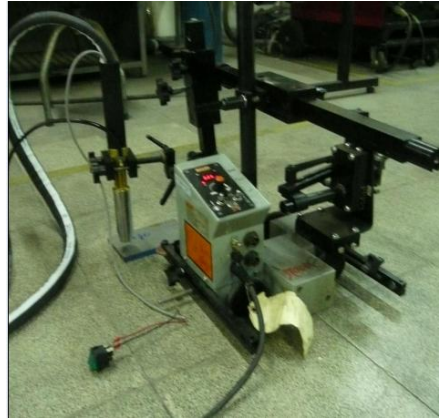
Şekil 4. 6 Moggy marka torç hareket ettirici elektrikli araba
