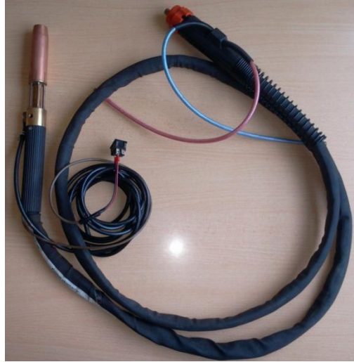
Şekil 4. 2 Toplanmış ve kablolanmış çift kanallı gazaltı kaynak torcu
