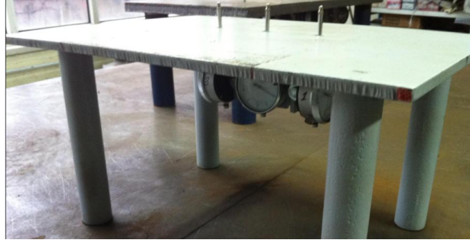
Şekil 4. 9 T-köşe kaynaklı numunelerin açılmal çarpılma ölçüm fikstürü
