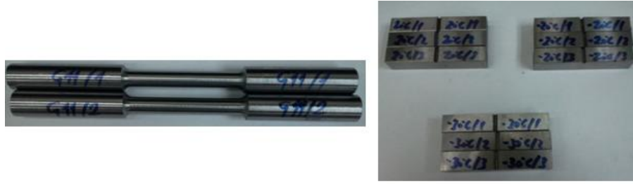
Şekil 4. 21 Çekme çubukları ve V- çentik darbe numuneleri
