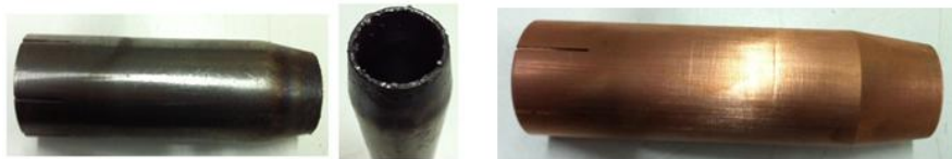
Şekil 4. 14 Çelikten imal edilmiş eski dış nozul (solda) ve bakırdan imal edilen yeni dış nozul (sağda)
