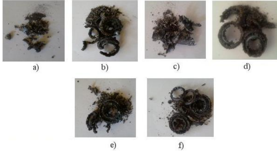
Şekil 5. 2 Starweld MCW-7100 metal özlü telle V-alın parçaların 14 paso ile kaynağında torcun nozulunda biriken çapaklar. a) Ç7-DMAG-7,5Ar-7,5CO 2 -MCW, b) Ç8-Karışım-%50Ar-%50CO 2 -MCW, c) Ç10-DMAG-9Ar-6CO 2 -MCW, d) Ç9-Karışım-%60Ar-%40CO 2 -MCW, e) Ç11-DMAG-6Ar-9CO 2 -MCW, f) Ç12-Karışım-%40Ar-%60CO 2 -MCW
