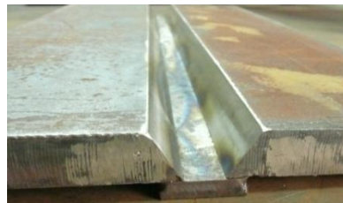
Şekil 4. 13 30°'lik kaynak ağzına sahip deney numuneleri
