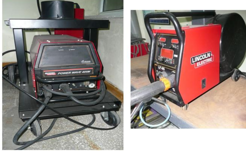
Şekil 4. 5 Lincoln Electric Powerwave 405M kaynak makinası ve LF45 tel sürme ünitesi
