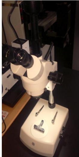
Şekil 4. 26 Makro fotoğrafların alınmasında kullanılan stereo optik mikroskop
