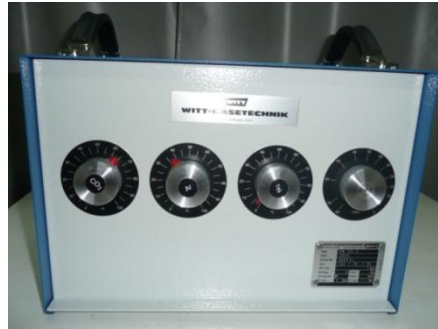
Şekil 4. 3 \text{Ar-CO}_2\text{-N}_2 gaz karışım cihazı
