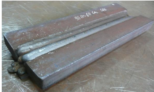
Şekil 4. 12 V- kaynak ağzına ve 20 mm kalınlığa sahip çift kanallı torç ve SG2 kaynak teli ile kaynak edilmiş ön deneme parçası (iç nozul: 9lt/dk Ar, dış nozul: 6lt/dk CO 2 )
