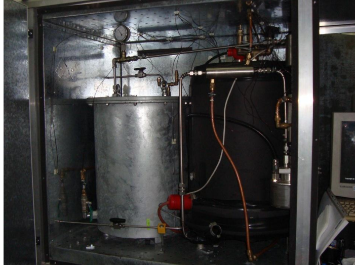
Şekil 3.12 Isı değıştirici kabini yerleşimi
