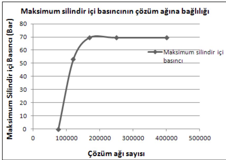
Şekil 6.3 Farklı çözüm ağlarına göre maksimum silindir içi basınç değerleri
