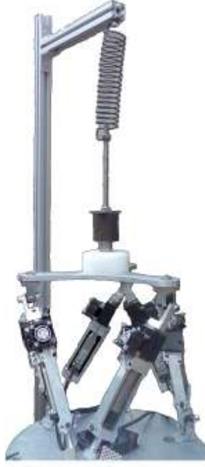
Şekil 7. 33 Kuvvet kontrol yöntemlerinin saydamlıklarını test etmek için oluşturulmuş test düzeneği
