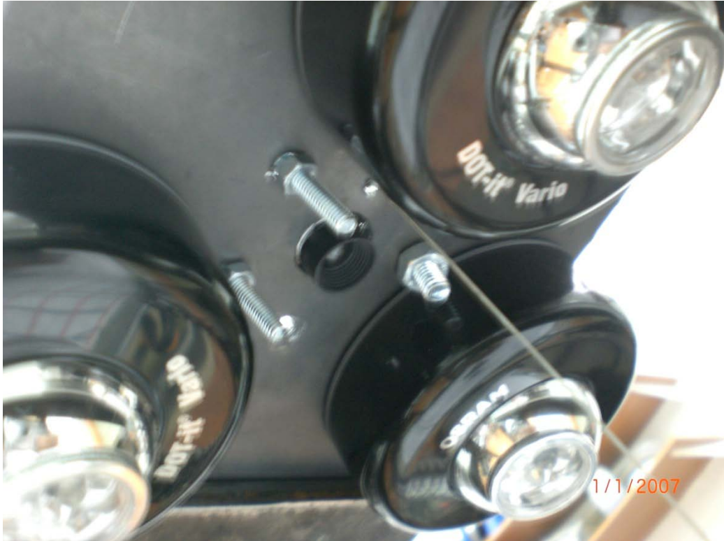
Şekil 4.2 Görüntü işlemede kullanılan kameranın ve kameranın etrafına yerleştirilmiş ışık kaynaklarının arabanın alt tarafından bakışla görünümü.
