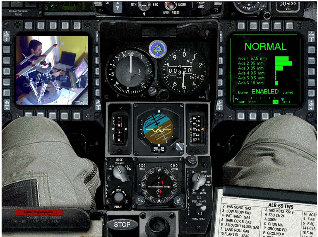
Şekil 6.2 Stewart Platformlu Kumanda Kolu’nun kullanıcı arayüzü. (Program görselinde kullanılan kokpit resmi Falcon-4 isimli oyundan alınmıştır.) Arayüzde gözüken düğmelerin hepsi kumanda sırasında gerekli ayarlamaları yapmak amacıyla çalışır konumdadır
