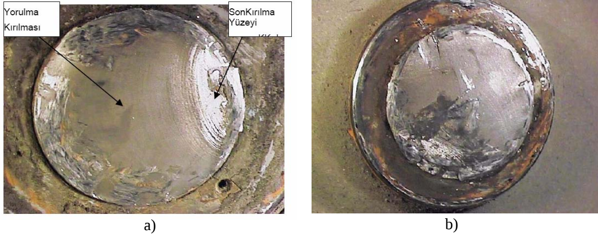
Şekil 6.3 Kırık parça yüzeyinden çekilen resim (a) dişli kutusu tarafından (b) tekerlek tarafından (LRT Aracı Aks Raporu, 2005).
