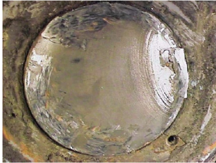
Şekil Ek 3.2 Kurtarma arabaları (565 no'lu araçta aks kırılması raporu, 2007).
