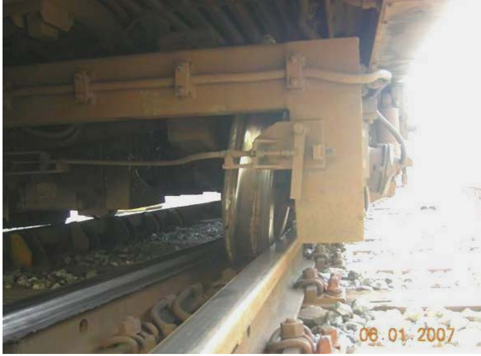
Şekil 6.4 Kırılan aks milinin tekerleği makasların arasına düşmüş durumda (565 no’lu araçta aks kırılması raporu, 2007).
