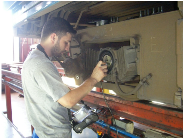
Şekil Ek 12.3 Akslar ultrasonik muayene yapılırken (Ulaşım A.Ş.Atölye Müdürlüğü )
