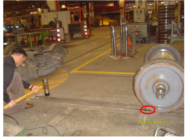
Şekil 4.22 Frekans analizi için darbe çekici ile sisteme darbe girişinin uygulanması.
