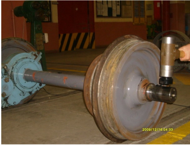
Şekil 4.22 Frekans analizi için darbe çekici ile sisteme darbe girişinin uygulanması.
