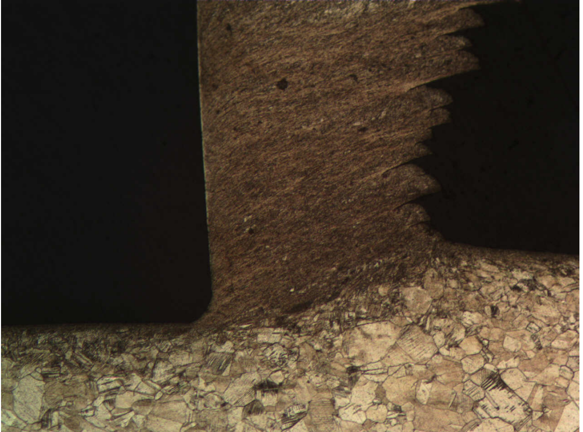
Şekil 5.15 Mikroskopla inceleme sonucunda görülen ölü bölge ( \gamma=0^\circ , r = 100 \mu\text{m} , V_c = 0,5 m/dak, t_1 = 150 \mu\text{m} )
