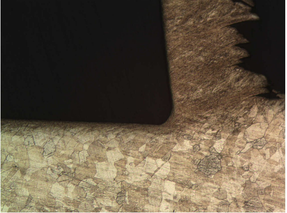
Şekil 5.19 Mikroskopla inceleme sonucunda görülen ölü bölge ( \gamma=6^\circ , r = 50 \mu\text{m} , V_c = 0,5 m/dak, t_1 = 50 \mu\text{m} )
