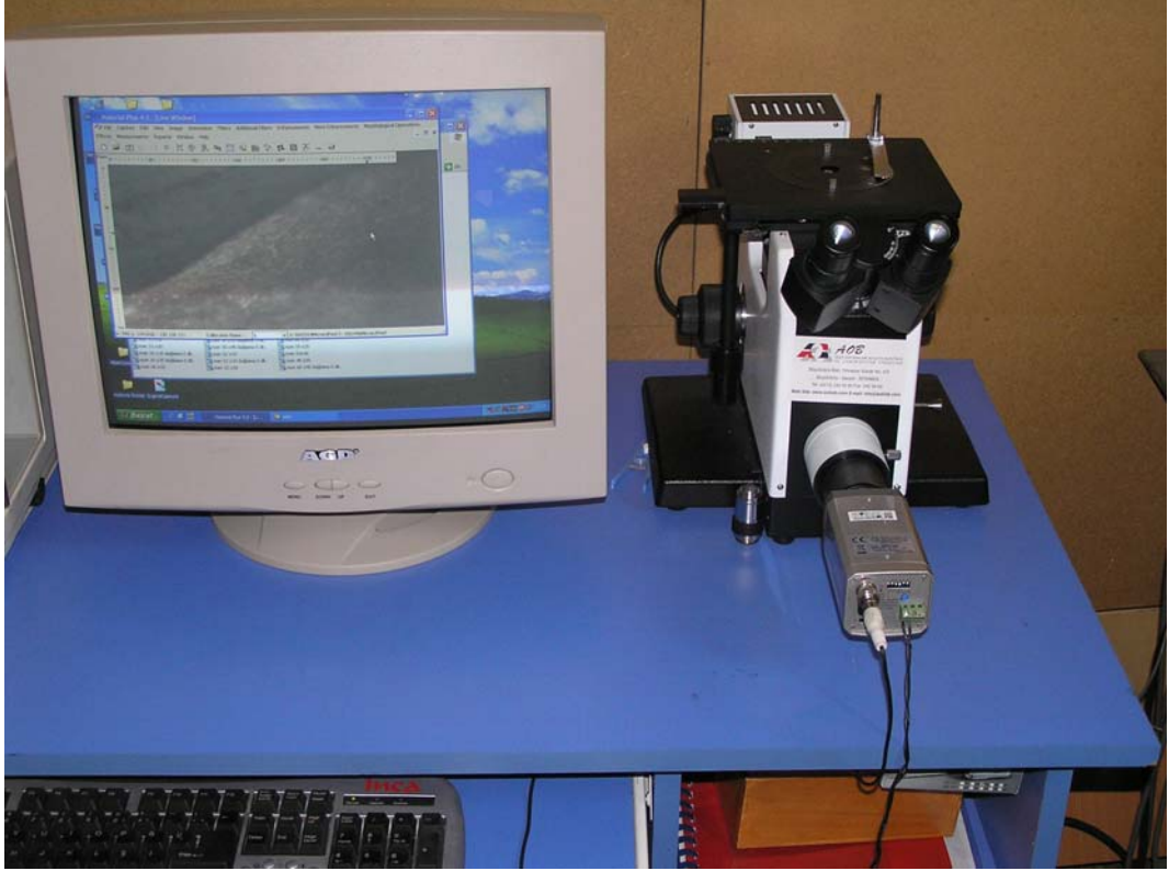
Şekil 4.7 Video okülere sahip XJP-2 model mikroskop ve bilgisayar
