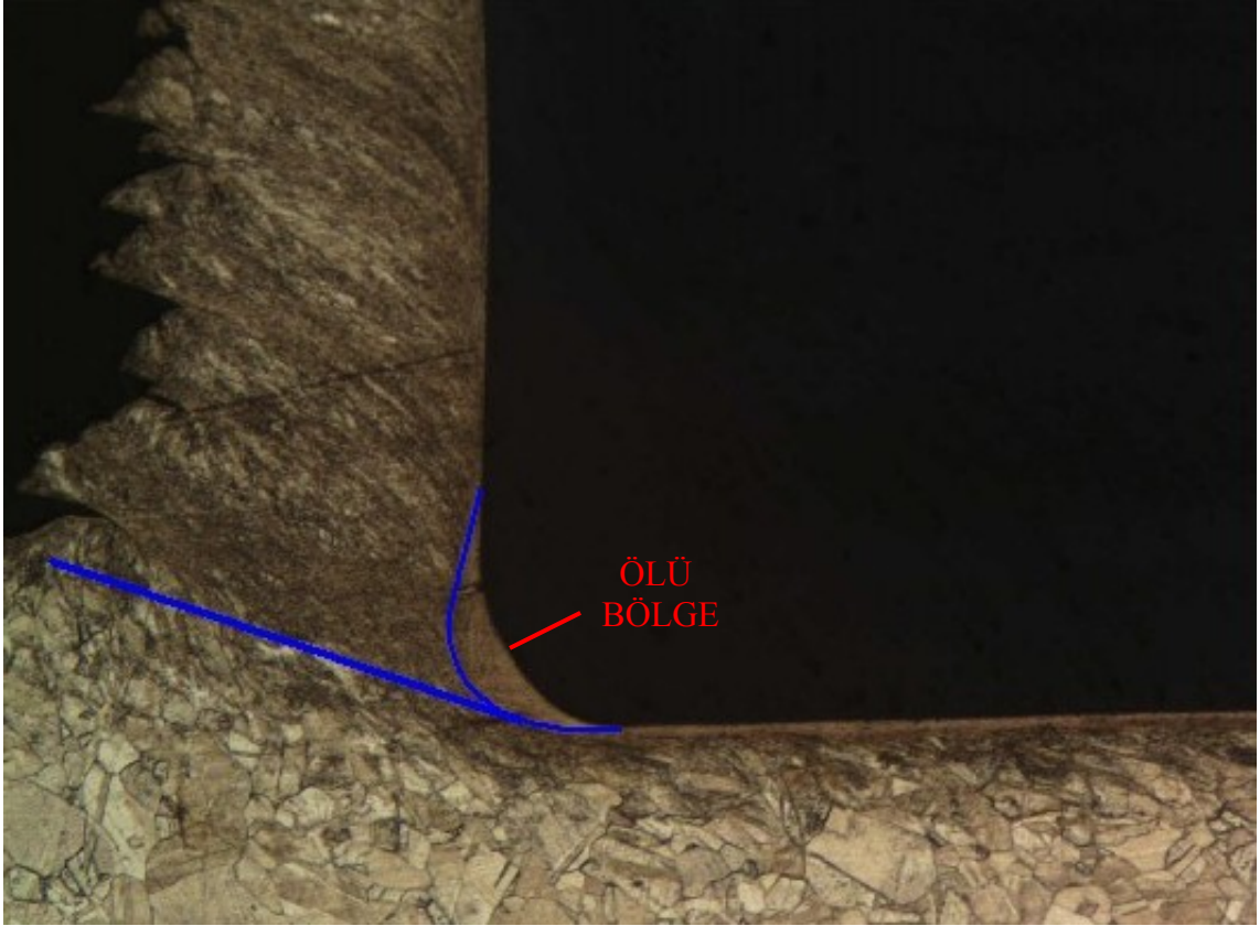
Şekil 5.12 Mikroskopla inceleme sonucunda görülen ölü bölge ( \gamma=0^\circ , r = 150 \mu\text{m} , V_c = 0,75 m/dak, t_1 = 100 \mu\text{m} )
