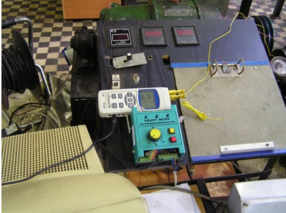
Şekil 5.9 Ortam ve karter yağ sıcaklığını kayıt eden dört kanallı termometre.
