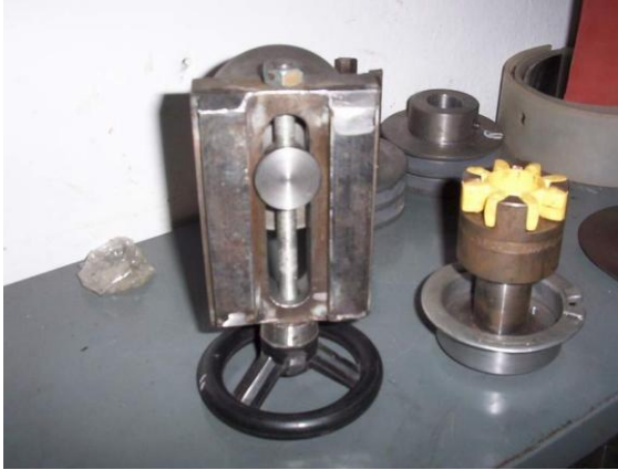
Şekil 5.11 Bağlantı için özel gerdirme aparatı ve kaplin.
