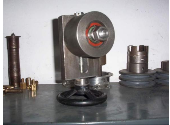
Şekil 5.11 Bağlantı için özel gerdirme aparatı ve kaplin.
