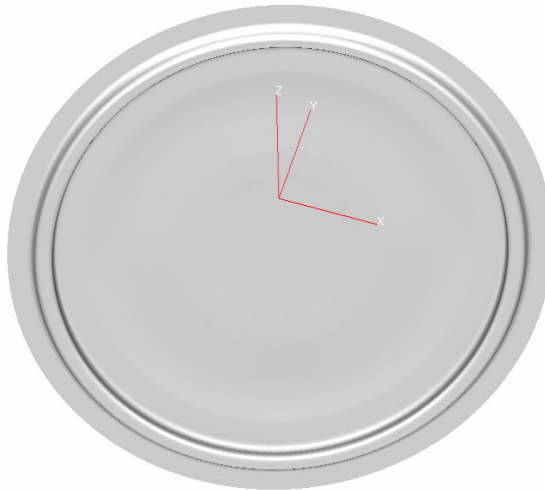
Şekil 3.68 İncelenen H 320 LA kalitesindeki çelik sac taslağın şişirilmesi sürecine geçilmeden önce pres tarafından uygulanan kuvvet ile kitleme işleminin PAM STAMP 2G yazılımı ile gerçekleştirilen simülasyonu
