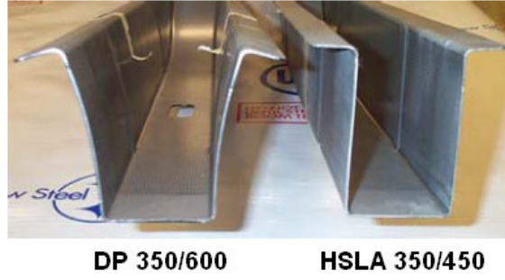
Şekil 2.14 Aynı mühendislik akma dayanımına ve eş gerinim aralığında ölçülmüş aynı pekleşme üssü değerine sahip DP ve HSLA çeliğinden sacların aynı kalıpta ve aynı şartlar altında kanal formunda şekillendirilmesinde ortaya çıkan geri esneme farklılaşması (IISI Committee, 2005)
