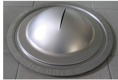
Şekil 3.61 Viskoz basınç ile şişirme deneylerinde numune olarak kullanılan dairesel taslağın kesim öncesi sac levha üzerindeki yerleşimi ile işaretlenen eksenler (a) ve kubbe formunda şişirilerek tepe noktasına yakın bir bölgeden yırtılmış durumdaki bir deney parçası (b)
