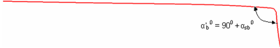
Şekil 4.4 Kenarı konkav formda bükülmüş sac parçaların merkez (simetri) eksenindeki kesitinde tanımlanan geri esneme açısı
