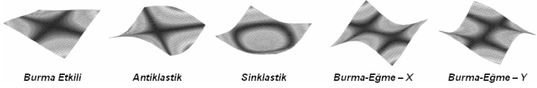
Şekil 1.5 Serbest olarak asılmış bir Poisson deney plakasının rezonanslı titreşiminde ortaya çıkan ilk beş tip şekil veya şekil modu (Lauwagie vd., 2003)
