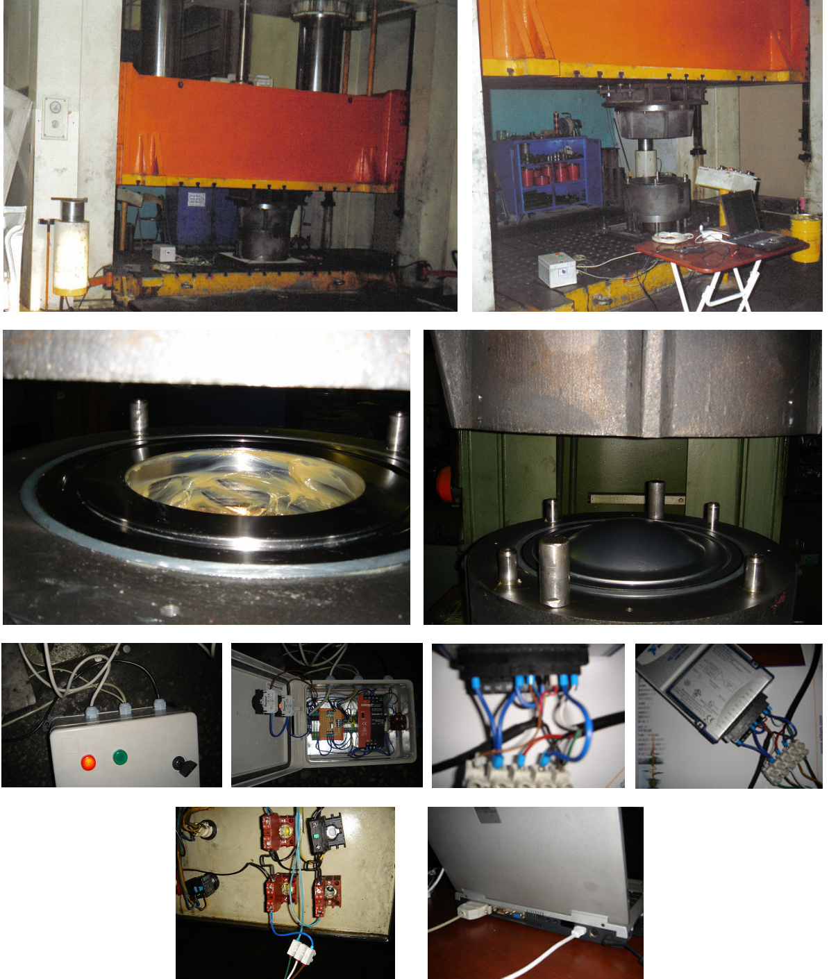
Şekil 3.59 Viskoz basınç ile sac şişirme deneylerinin yürütüldüğü düzenek ile veri toplama ve hidrolik presin üst tablasının kontrolü için hazırlanan elektrikselsistemden bazı kesitler
