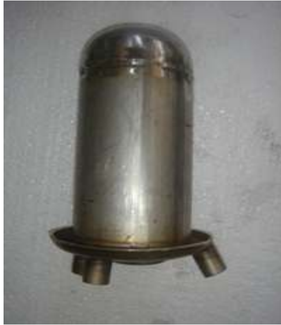
Şekil 4.6 İkinci Isıtıcı İçinde Elektrikli Isıtıcının Yerleştirildiği Paslanmaz Kabın Fotoğrafı
