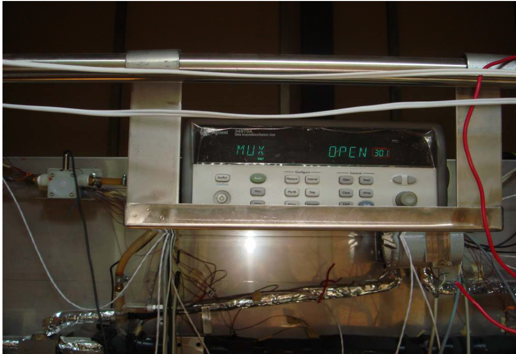
Şekil 4.18 Veri Toplama Ünitesi (Datalogger)
