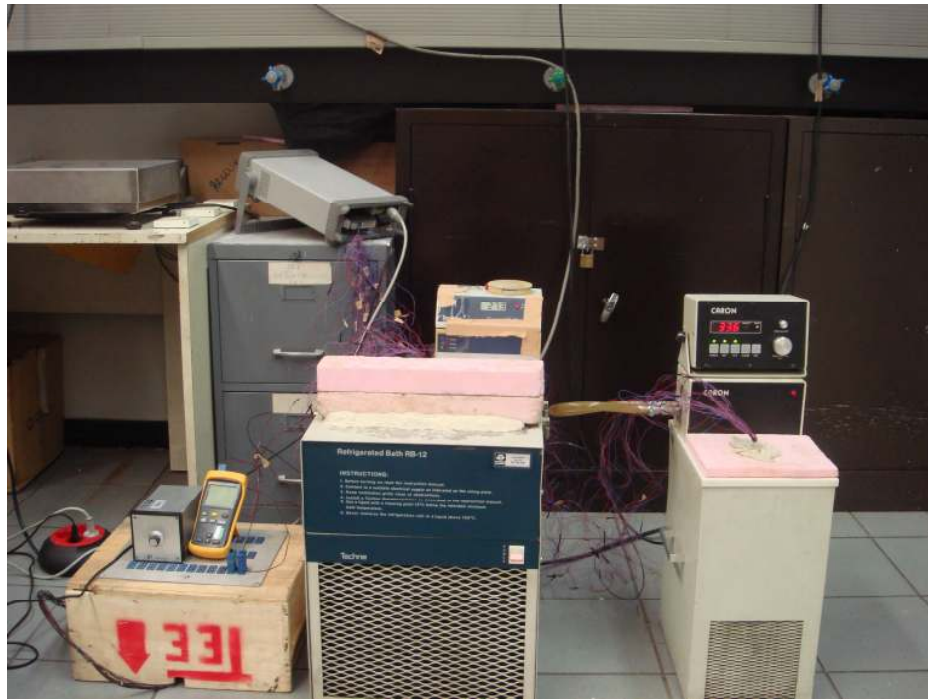
Şekil 4.20 ( T_{\text{doyma}}-T_{\text{duvar}} ) sıcaklık farkını veren termoelemanların kalibrasyon esnasındaki fotoğrafı
