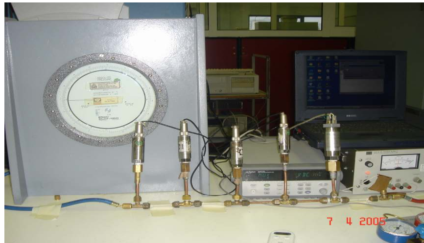
Şekil 4.21 Basınç Transmitterlerinin Kalibrasyon Sırasındaki Fotoğrafi
