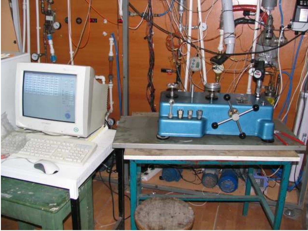
Şekil 4.14 Deney tesisatında kullanılan bilgisayar ve basınç kalibratörü
