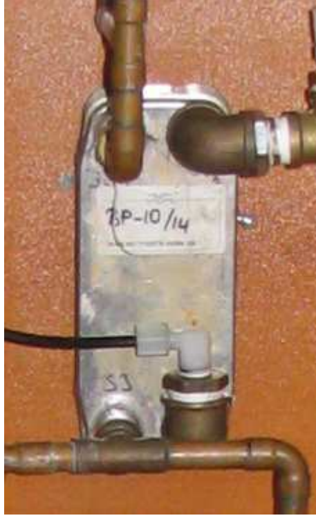
řekil 4.10 Deney tesisatında buharlařtırıcı ve yoęuřturucu amaçlı olarak kullanılan plakalı ısı deęiřtiricisi
