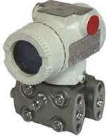
Şekil 4.8 Deney tesisatında kullanılan 4-20 mA çıkışlı basınç ölçer
