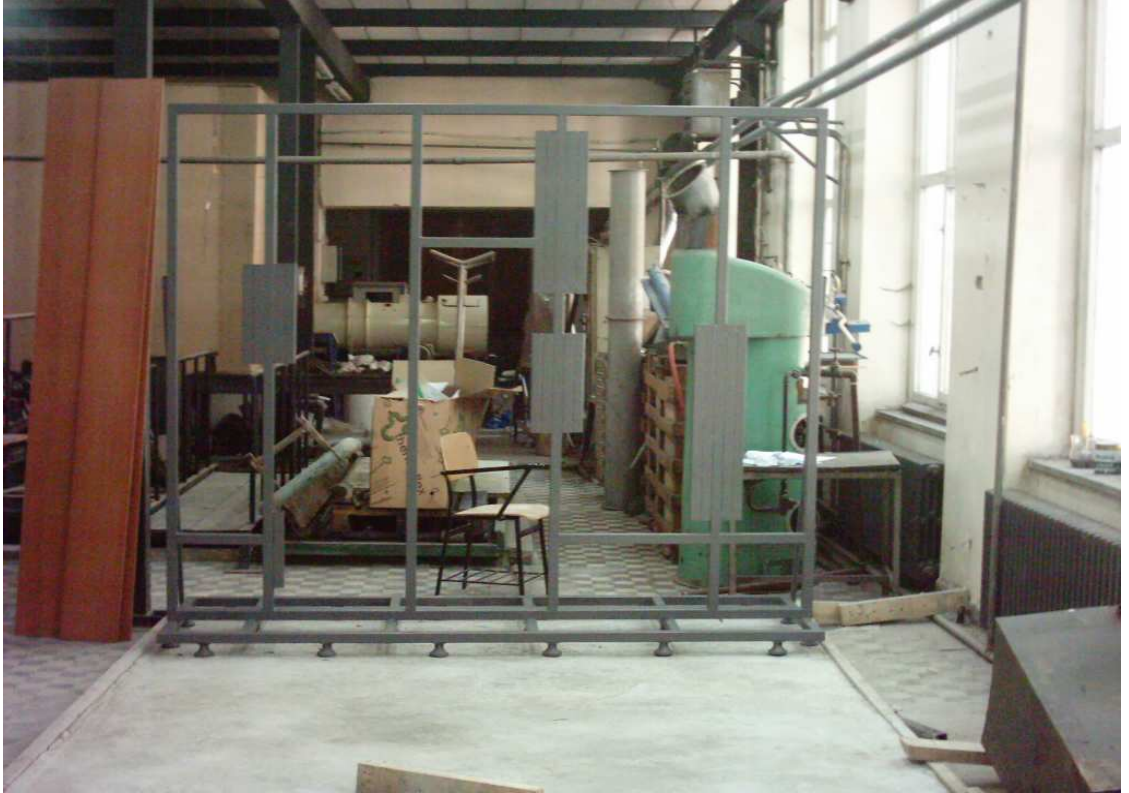
řekil 4.11 Deney tesisatının kaidesi
