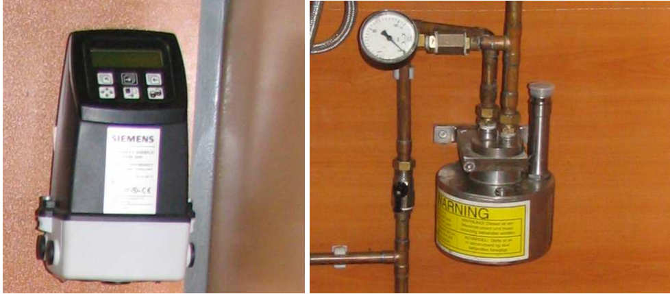
Şekil 4.9 Deney tesisatında kullanılan dijital göstergeli, 4-20 mA çıkışlı R134a debimetresi
