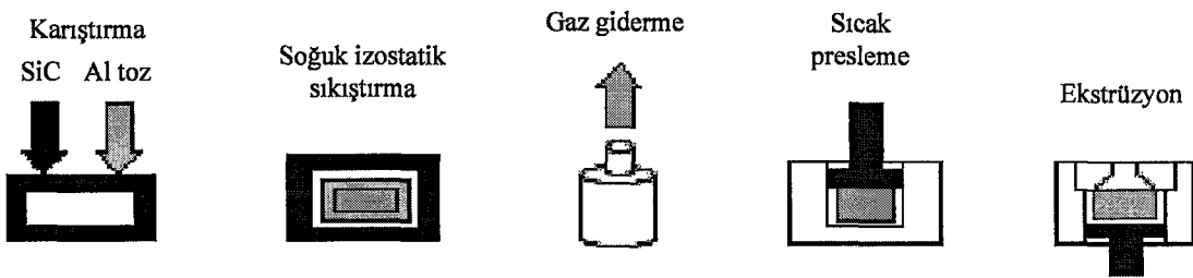
Şekil 3.1 Toz metalurjisi yönteminin temel aşamaları
