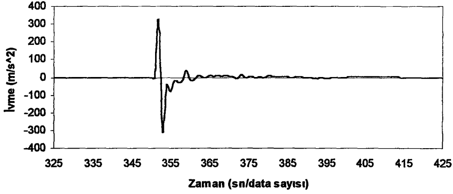
Şekil 4.17. Ayna dişlisi üzerinden zaman modunda ölçülen çevresel titreşimin ivme değeri (Resim 4.5'deki ayna dişlisinin yan tarafında, ikinci örnek, RMS = 17.668 \text{ m/s}^2 )
