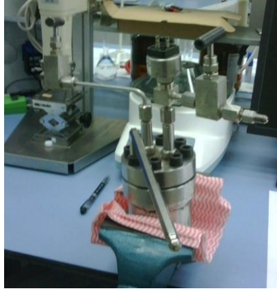
Şekil 4.3 LTE'e numune yükleme aşaması
