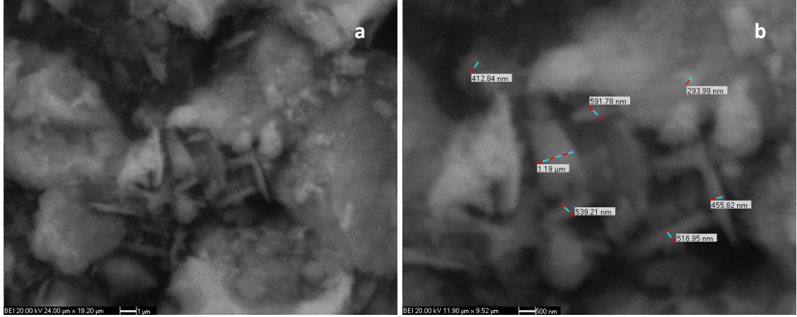
Şekil 3. 78 Y 4 : M-H'den 600W 1:4 mol oranındaki üretimin SEM görüntüleri, a.5000x, b. 10000x
