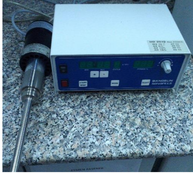
Şekil 2. 8 Bandelin Sonoplus marka, HD 2070 model ultrasonik prob
