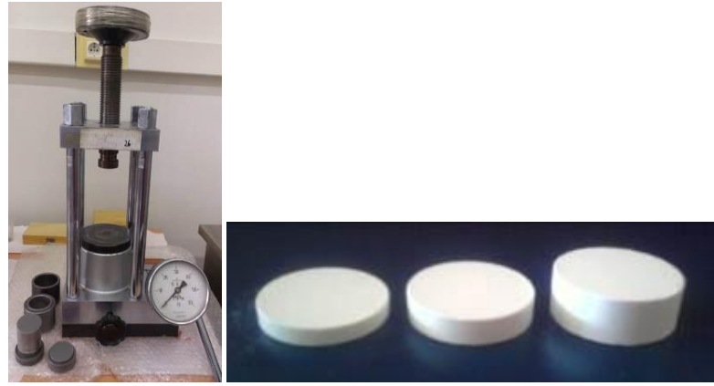
Şekil 2. 14 a. Manfredi OL57 hidrolik pres, b. Pelletlenmiş admontit mineralleri
