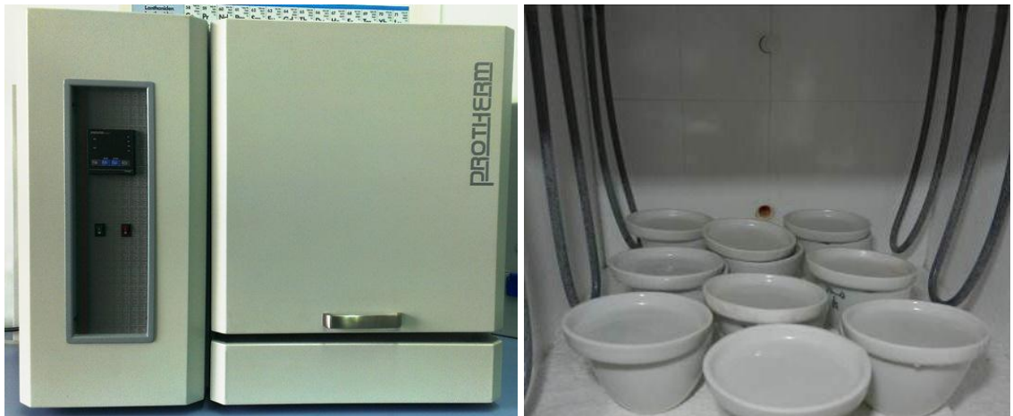
Şekil 2. 11 a. Protherm yüksek sıcaklık fırını, b. Fırın içindeki numuneler
