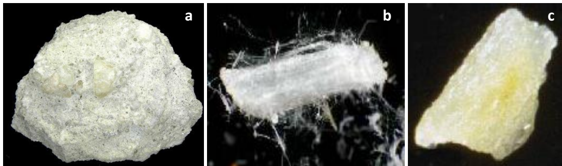
Şekil 1. 9 Klorlu Mg-borat mineralleri, a. borasit, b. shabinit, c. karlit [18]
