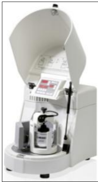
Şekil 6. 3 Mekanik öğütücü, öğütme kabı ve bilyalar
