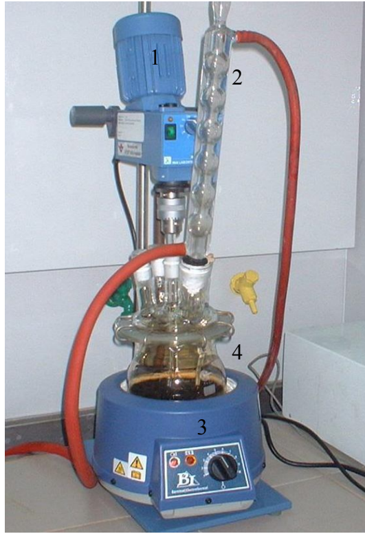
Şekil 6.1 Ön yıkama işlemleri deney düzeneği (1.mekanik karıştırıcı, 2.geri soğutucu, 3.balon ısıtıcı, 4.reaktör)
