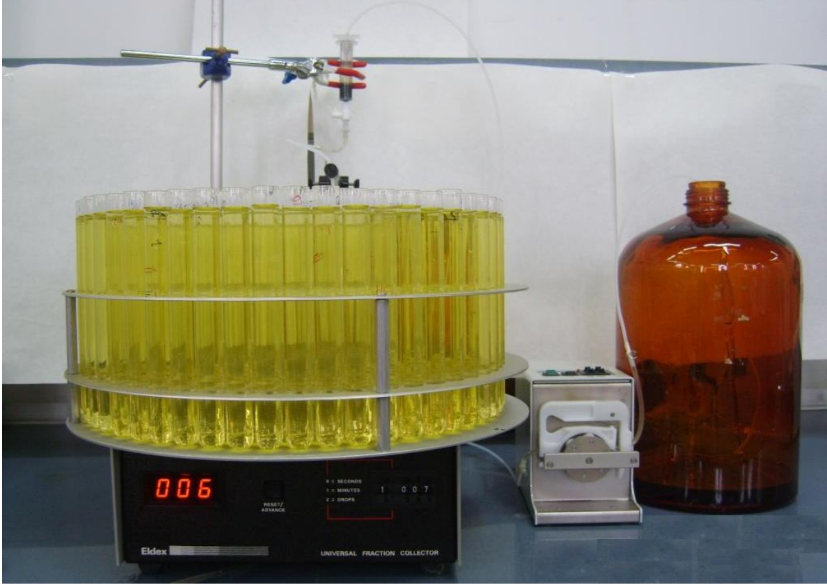
Şekil 7.1 Sürekli akışlı sistemde Cr(VI) sorpsiyonu deney düzeneği
