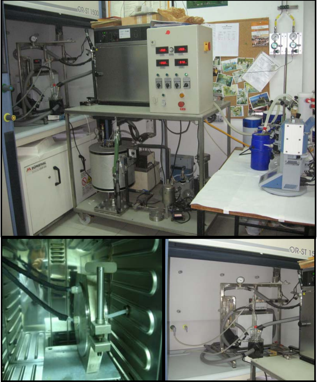
Şekil 4.5 Geri döngülü kesikli pervaporasyon sistemi
