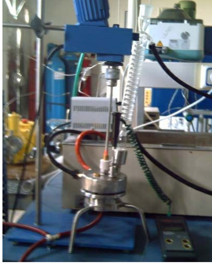
Şekil 4.2 Geri döngüsüz pervaporasyon membran reaktör hücresi
