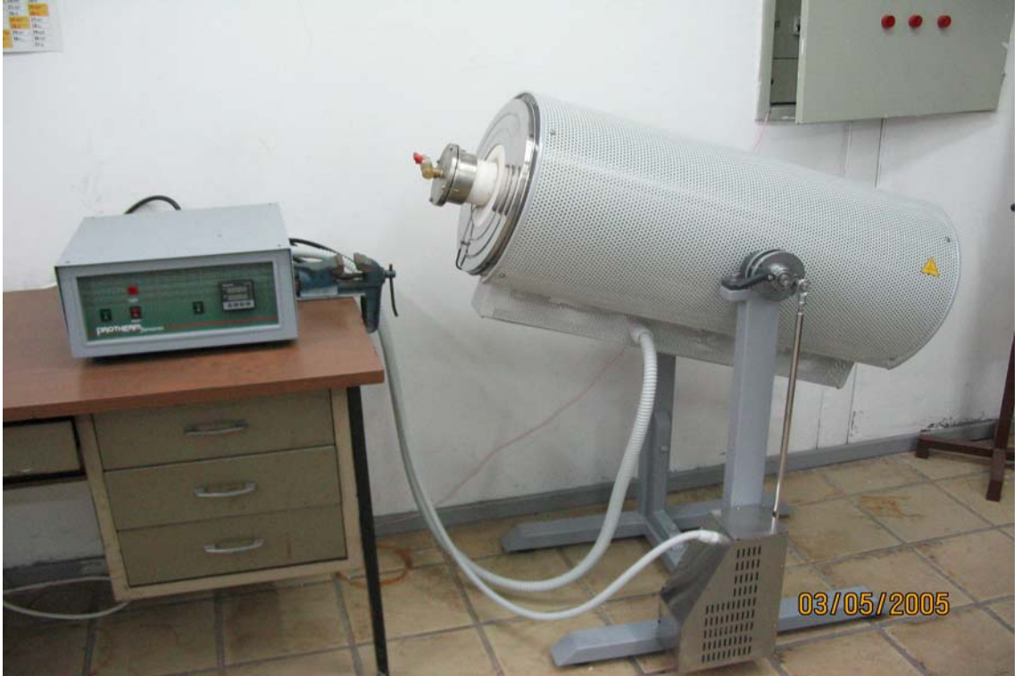
Şekil 7.8 Alaşım üretiminde kullanılan boru tipi hareketli fırın
