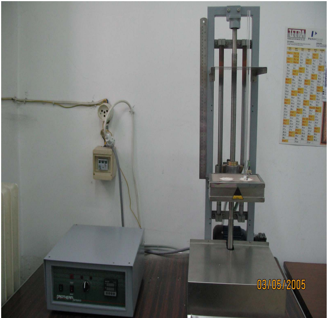
Şekil 7.9 Alaşım üretiminde kullanılan kristal büyütme sistemi
