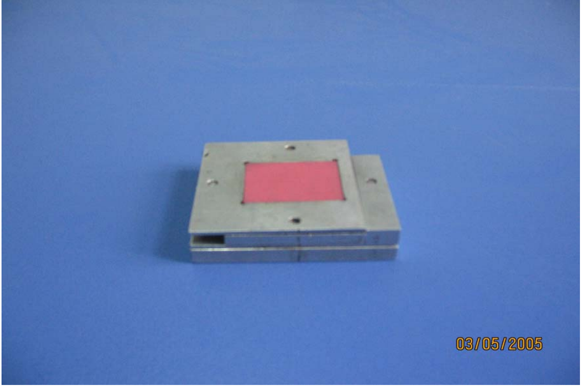
Şekil 7.42 Termoelektrisel batarya üretim kalıbı
