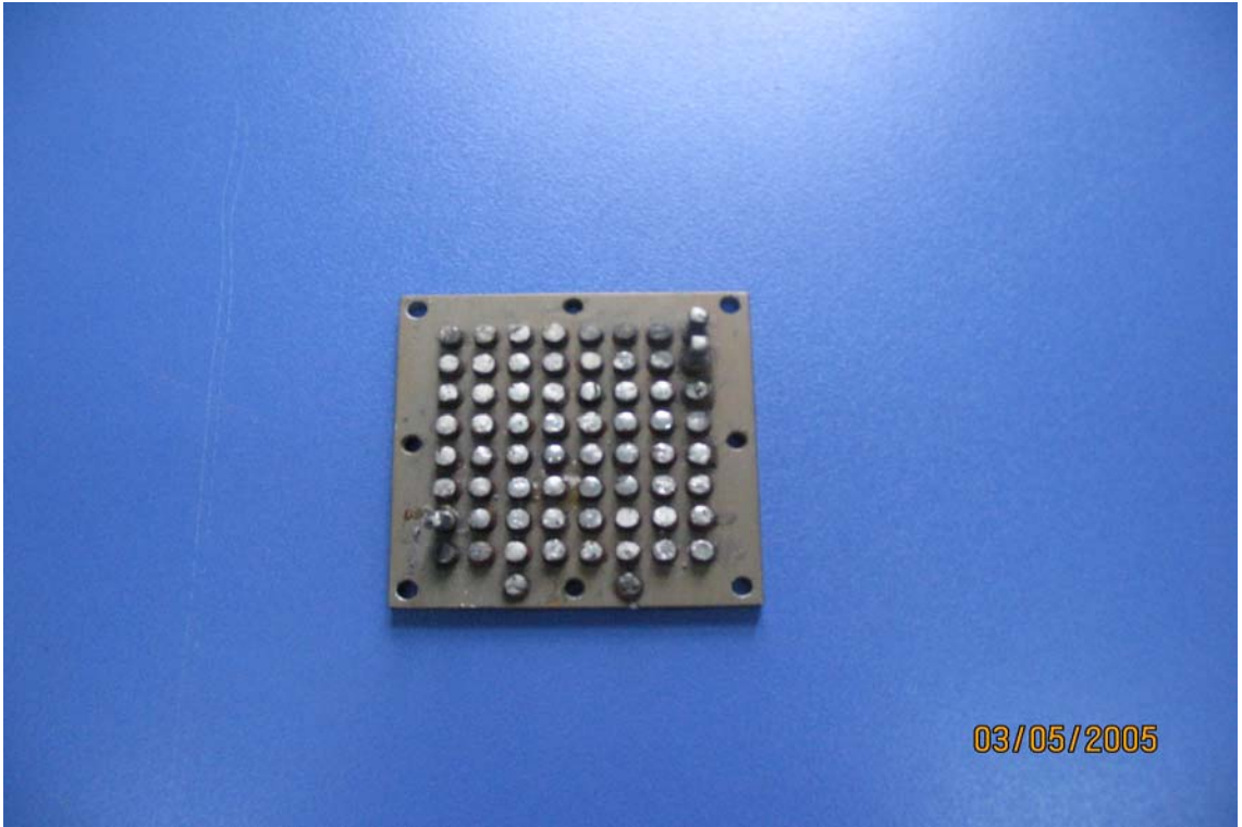
Şekil 7.43 Üretilen alaşımların yerleştirildiği bakır bağlantılı kalıp
