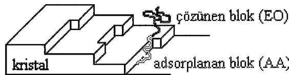
Şekil 3.4 EO-b-AA kopolimerinin kristal yüzeyinde büyüme basamaklarına tercihli adsorpsiyonu
