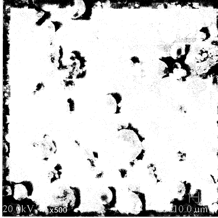
Şekil 4.46 Tunçbilek 1 uçucu külünün SEM kullanılarak çekilen görüntüsü
