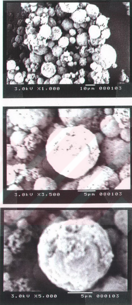
Şekil 3.6 PEG 4000-sodyum akrilat esaslı polimerin SEM mikrografığı
