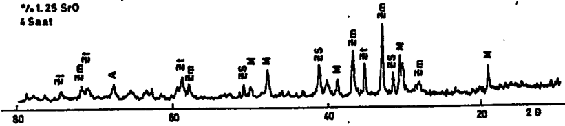
Şekil 9.16 1500°C da 2 ve 4 saat sinterlenmiş katkısız ve %1.25 SrO katkılı bileşimlere ait difraksiyon eğrileri, A:alümina, ZS:zirkon, M:mullit, Z 1 :monoklinik zirkonya, Z 2 :tetragonal zirkonya.
