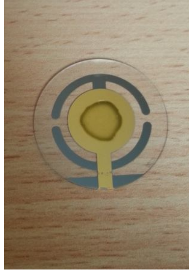
řekil 3. 7 QCM  l  mlerinde kullanılan polimer ince film kaplı kuvars elektrot
