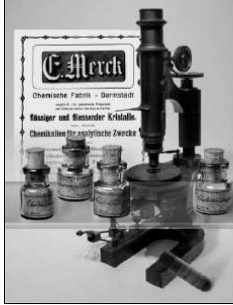
Şekil 2.2 Lehmann'ın orijinal kristalizasyon mikroskobu ve ilk sentezlenen bazı MERCK sıvı kristal maddeler (Cristaldi vd., 2009).
