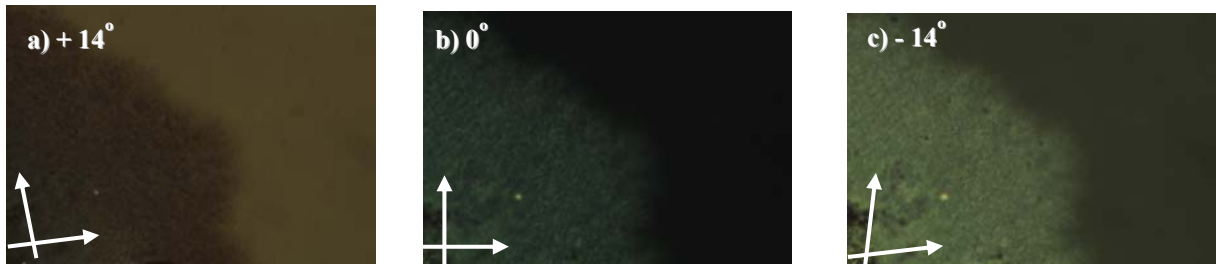
Şekil 5.214 Bileşik 41 'in soğutma DSC termogramı ve 141.0 °C'deki "dark conglomerate" mesofaz tekstürü, polarizörlerin yönünün değiştirilmesiyle kiral "domain"lerin açık-koyu bölgeleri tersine çevrilmektedir; a) polarizörün +14° değişimi; b) çaprazlanmış polarizör-analizör; c) polarizörün -14° değişimi.
