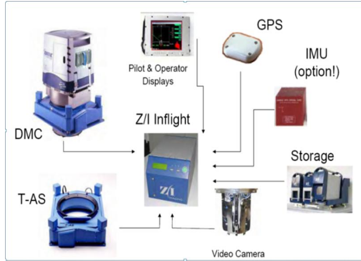
Şekil 3. 3 DMC dijital kamera bileşenleri
