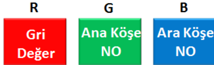
Şekil 4. 29 Köşe numaralarının saklanması için kullanılan RGB kodlaması
