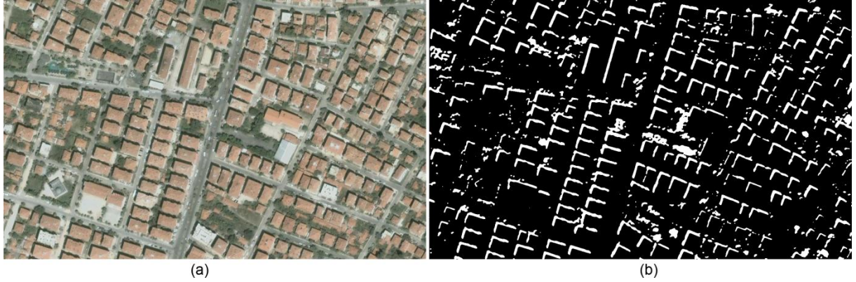
Şekil 4. 43 Bina gölgelerinin eşik değeri belirleme ile ayırt edilmesi, a: Orijinal görüntü, b: Eşik değeri kullanılarak elde edilen bina gölgeleri
