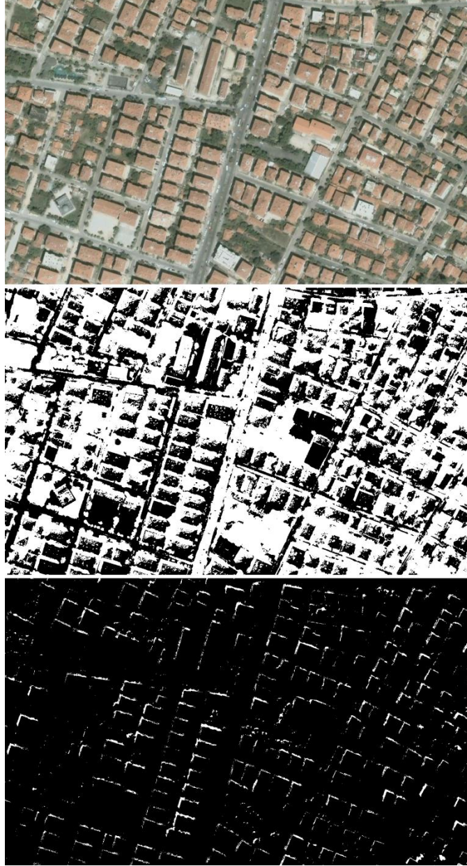
Şekil 4. 42 Bina gölgesi belirlemede eşik değeri yanlış belirlenmesi
