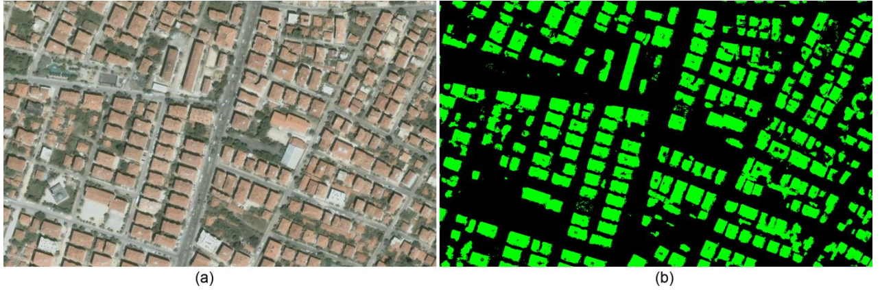
Şekil 4. 5 a: Orijinal uydu görüntüsü, b: Görüntü işleme koşulları uygulanmış sonuç görüntü
