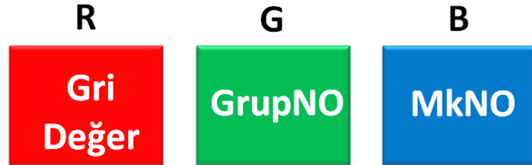
Şekil 3. 47 Grup numaralarının saklanması için kullanılan RGB kodlaması
