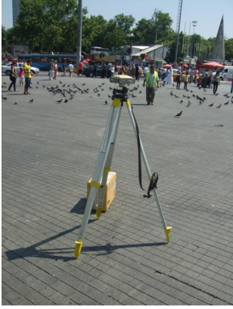
Şekil 4.20 Poligon tesisi ve GPS ile koordinatlandırılması
