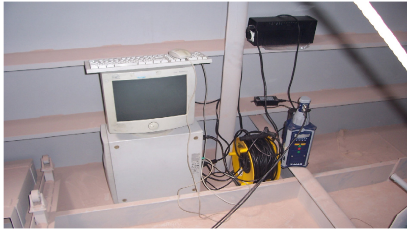
Şekil 5.6 Beylerbeyi kule içine yerleştirilen GPS alıcısı ve bilgisayar donanımı
