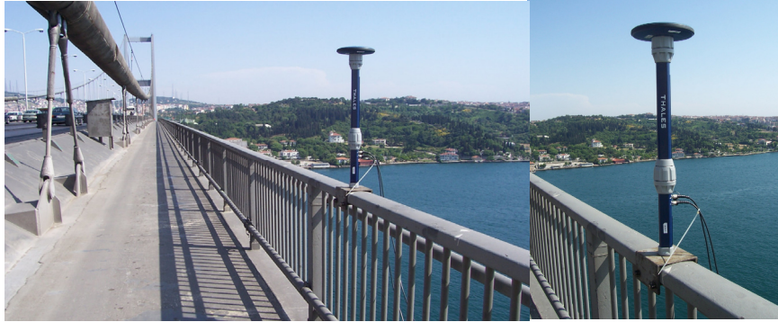
Şekil 5.8 T1 numaralı noktadaki GPS ve modem anteni
