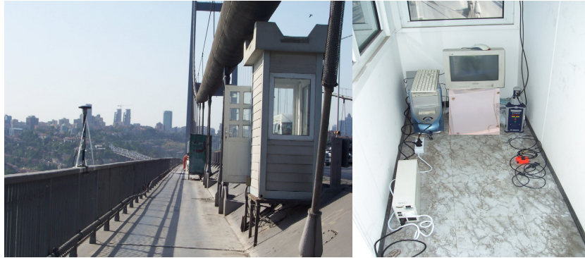
Şekil 5.9 T1 numaralı noktadaki GPS alıcısı ve bilgisayar donanımı
