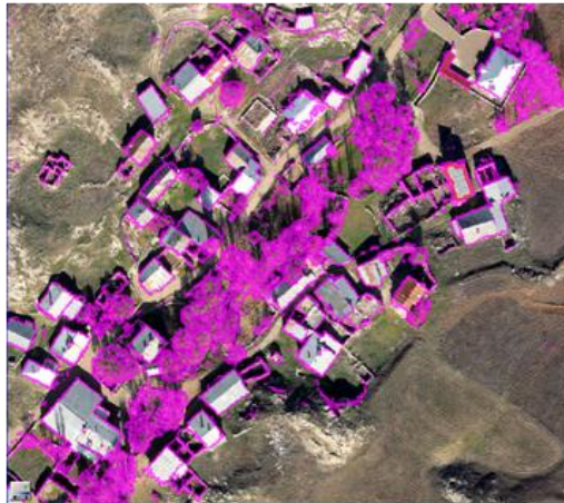
Şekil 4. 54 Çalışma Alanı (2) için oluşturulan çoklu çözünürlüklü segmentasyon sonucu Bina iyileştirilmesi aşamasında, oluşturulan bina sınıfı kullanılarak Bina_4 ve Yerden yüksek objeler_2 sınıflarına ilişkisel sınıf özelliği kullanılarak bina sınırları Bina sınırı_1
