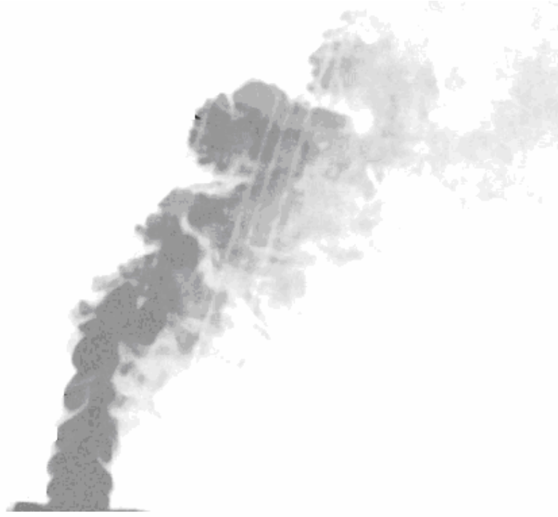
Şekil 1.9 PLIF ile elde edilen akış durumu ve kayma tabakası girdapları, (Rivero vd., 2001).
