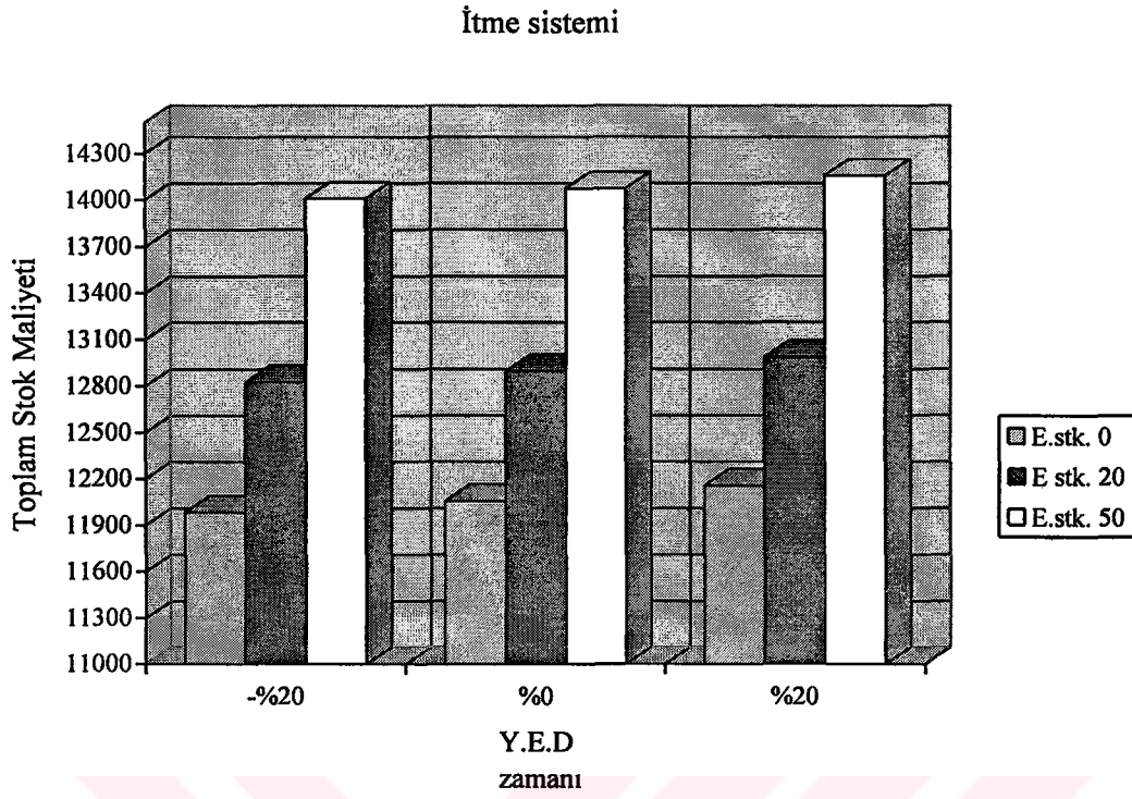
Şekil 8.3 İtme sistemini kullanan üretim sisteminin mevcut talebin %20 azaltılması durumunda performans (TSM) değerleri
