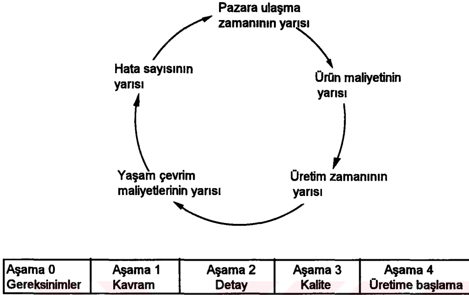
Şekil 3.17. Eş zamanlı mühendisliğin uygulanma amaçları (Hartley, 1992).
