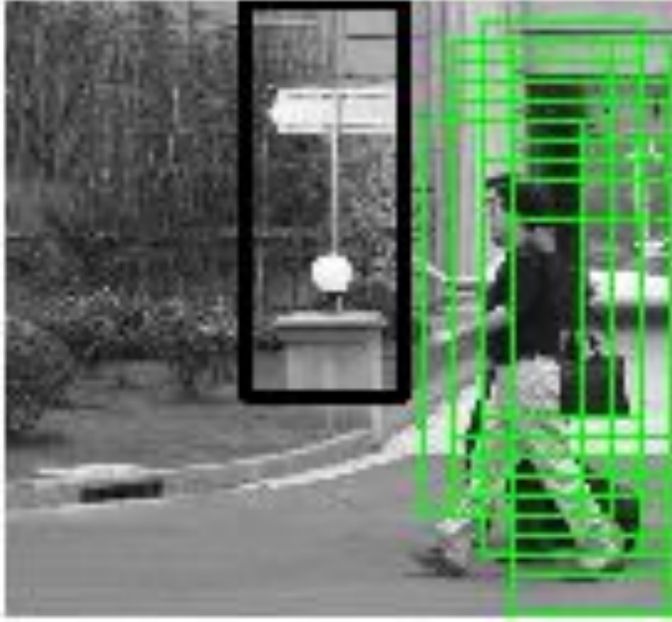
Şekil 4. 5 Sobel filtresinin uygulanmasının ardından yaya aday bölgeleri. Kalın siyah dikdörtgenle gösterilen aday bölge Sobel filtresi tarafından elenmiş durumda [21]
