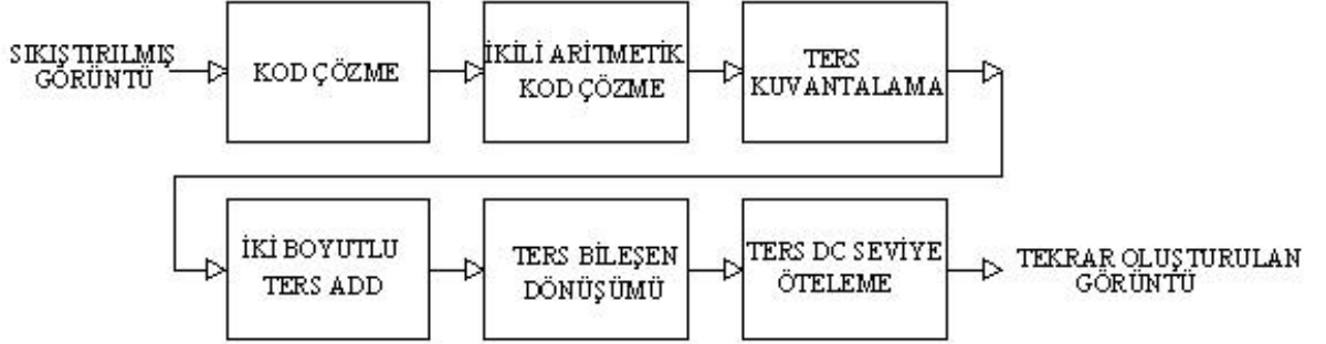
Şekil 3.7 JPEG 2000 kod çözümü blok yapısı
