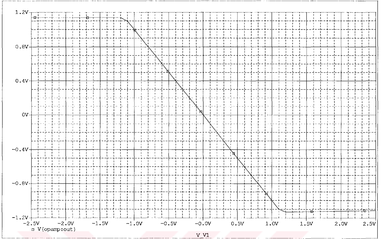
Şekil 4.3 İşlemsel Yükseltici devresinin çalışma gerilim aralığında eviren cevabı
