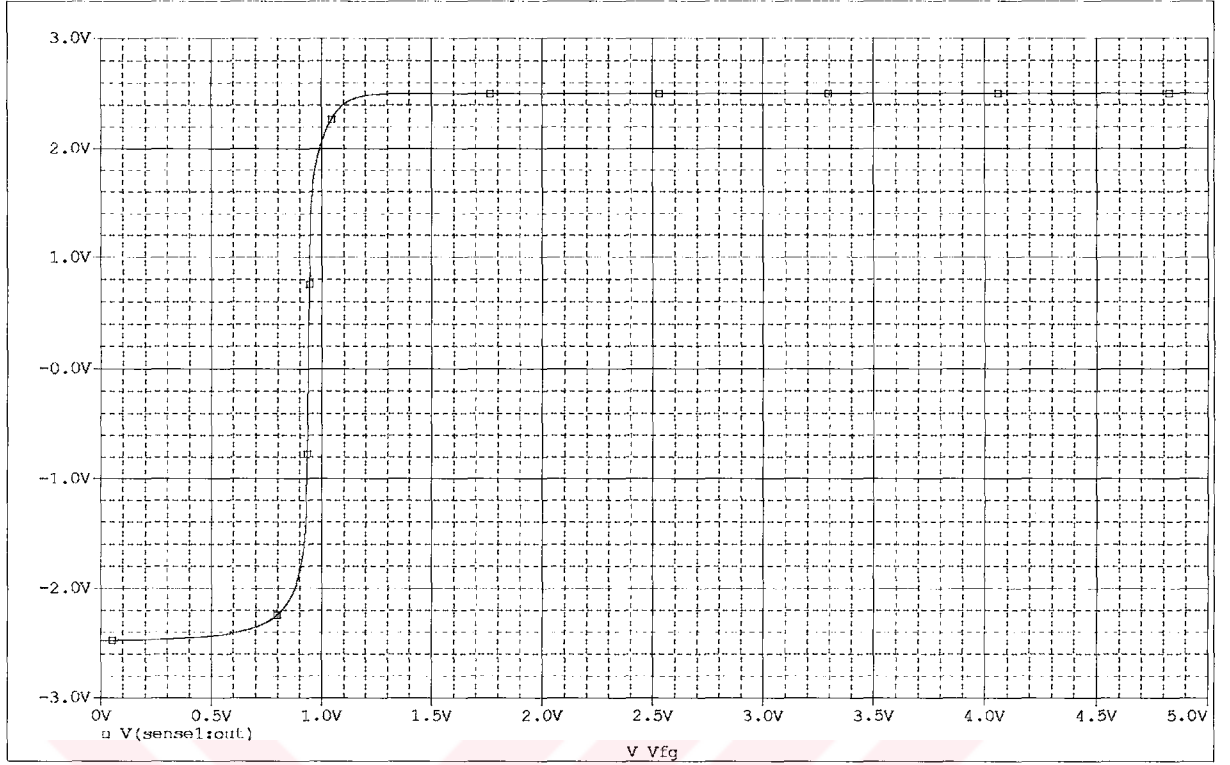
Şekil 4.64 Analog işareti kontrol eden hafıza hücresi algı yükselticisinin benzetim sonuçları
