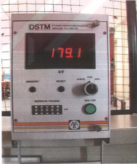
Şekil Ek 1.13 Darbe gerilimini ölçmeye yarayan darbe voltmetresi
