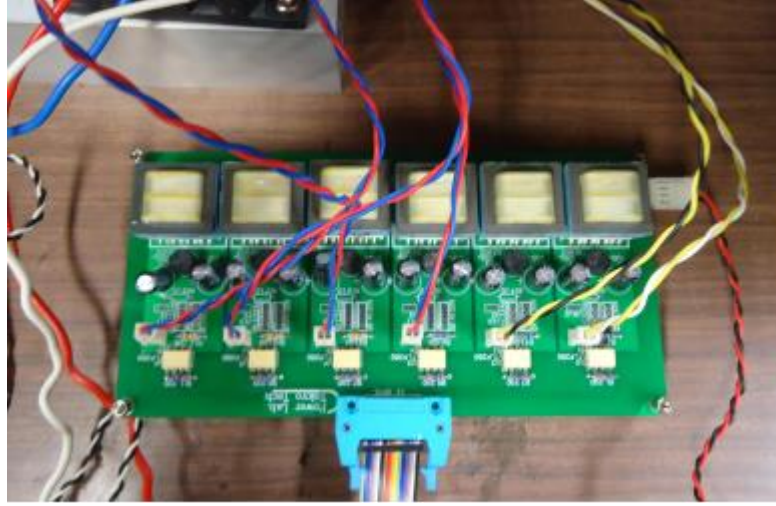
Şekil 6.22 IGBT-IPM modül için gerçekleştirilen izolasyon devresi
